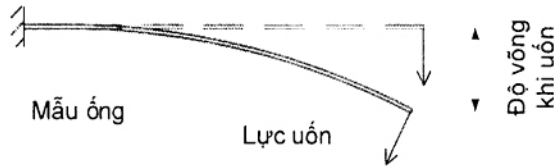
Hình 8 – Sơ đồ thử nghiệm khả năng chống gãy gập
